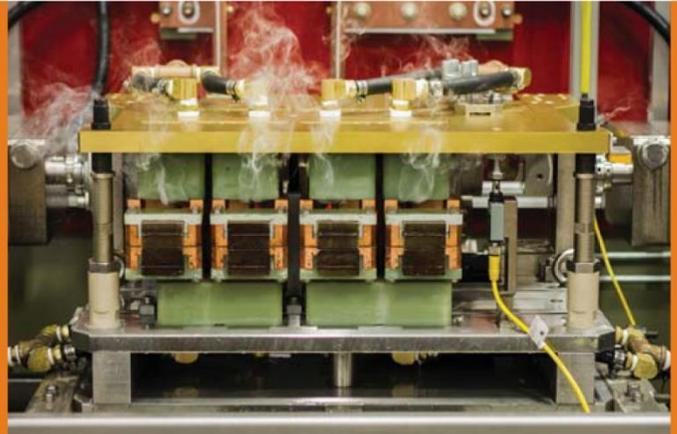
Die Induktionserwärmung ist eine bewährte Methode für die Wärmebehandlung verschiedener Automotive-Komponenten, einschließlich Nockenwellen, die der Gruppe der kritischen Motor-/Antriebsstrangkomponenten angehören. Ein neuer Ansatz macht jetzt eine Induktionshärtung der Nockenwellen mit nahezu nicht nachweisbarem Verzug möglich.
