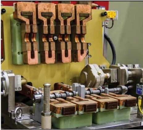
Abb. 3. CamPro™ Maschine verwendet patentierte Härtungstechnologie ohne Rotation (SHarP-C™ Technologie)
