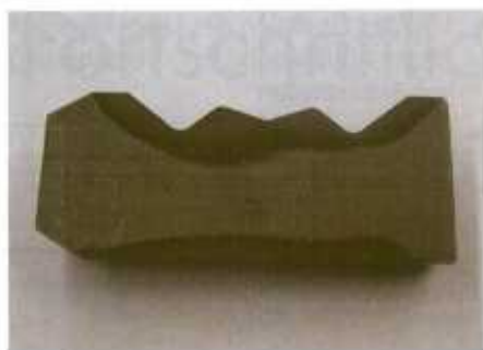
Bild 3: Mehrere Kantenübergänge ohne Durchhärtung an einer Schaltstange
