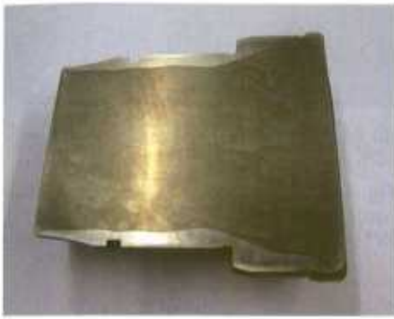
Bild 6: Kantenübergang mit Einkerbung an einer Antriebswelle
