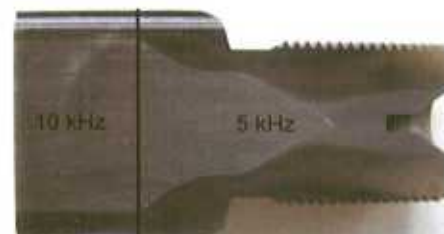
Bild 5: Zwei verschiedenen Frequenzen in einem Härteprozess
