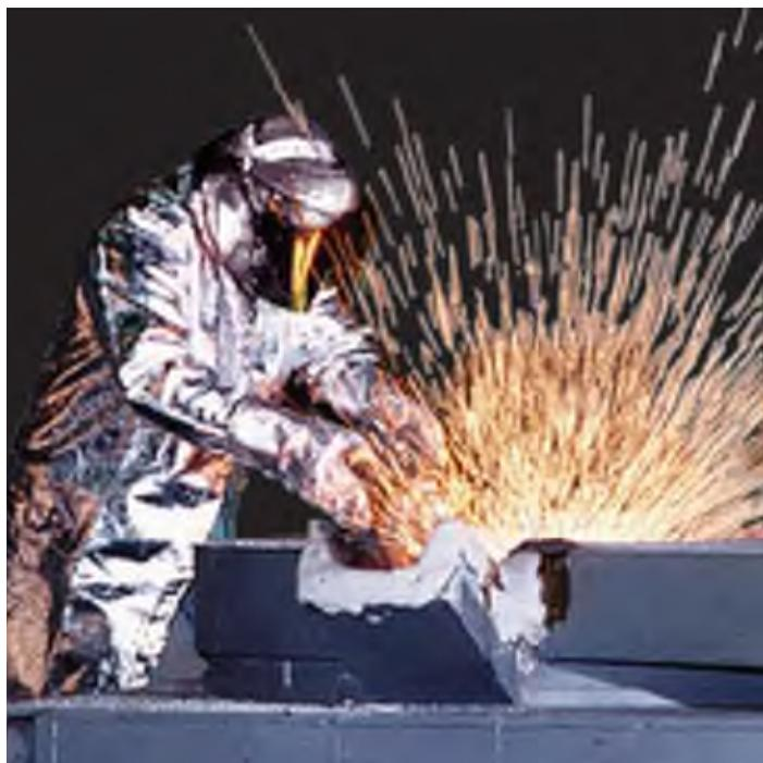
Средства индивидуальной защиты (СИЗ), включая алитированную куртку, алитированные перчатки и полный капюшон помогают защитить этого рабочего от брызг жидкого металла или выброса при завалке.
