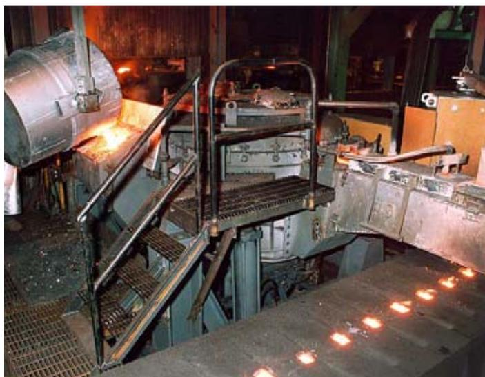
*Автоматическая система разливки удаляет работника литейного цеха от расплавленного металла.*
