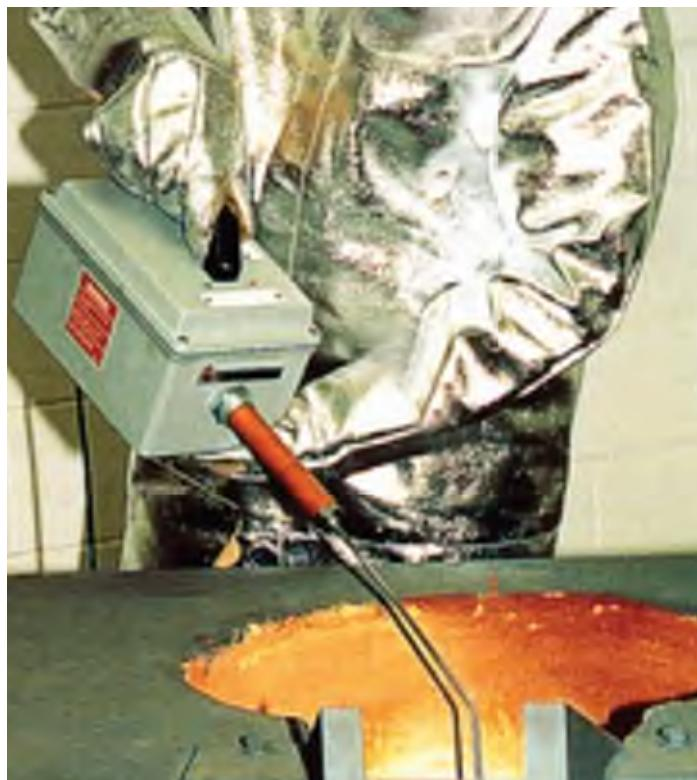
*Ручное устройство проверки зонда утечки на землю контролирует целостность системы зонда печи. Обращаем внимание на использование средств индивидуальной защиты (СИЗ).*
