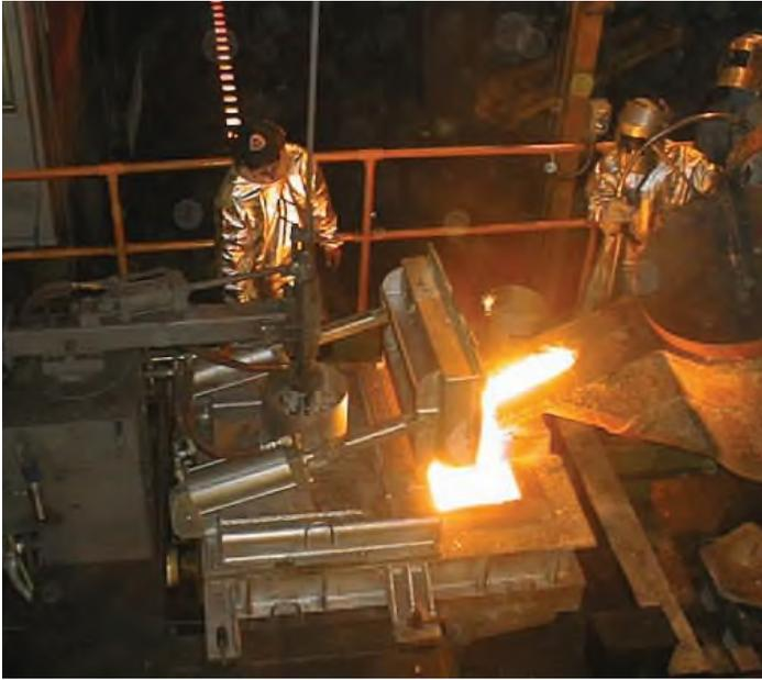
Выше показана система автоматического устройства разливки железа с элементами управления фирмы Visipour®
