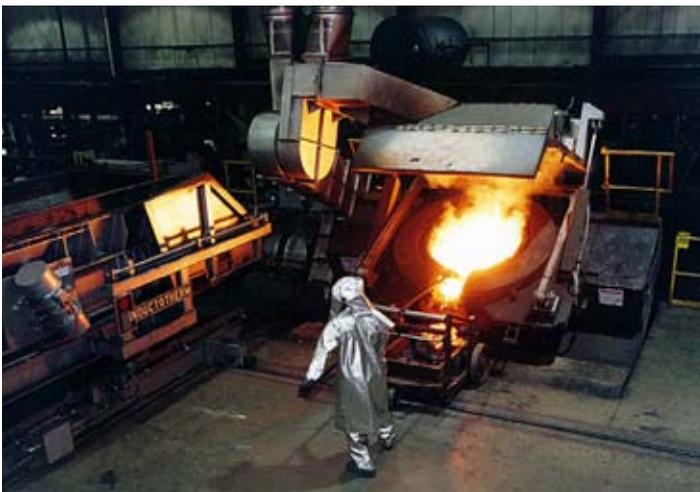
Рабочий литейного цеха ошлаковывает печь, оборудованную механизмом обратного спуска шлака, разработанным для облегчения удаления шлака.
