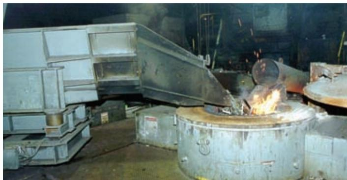
Когда поворотный конвейер или другая автоматическая система используется для заправки печи, оператор может оставаться в безопасности позади или за защитным барьером.
