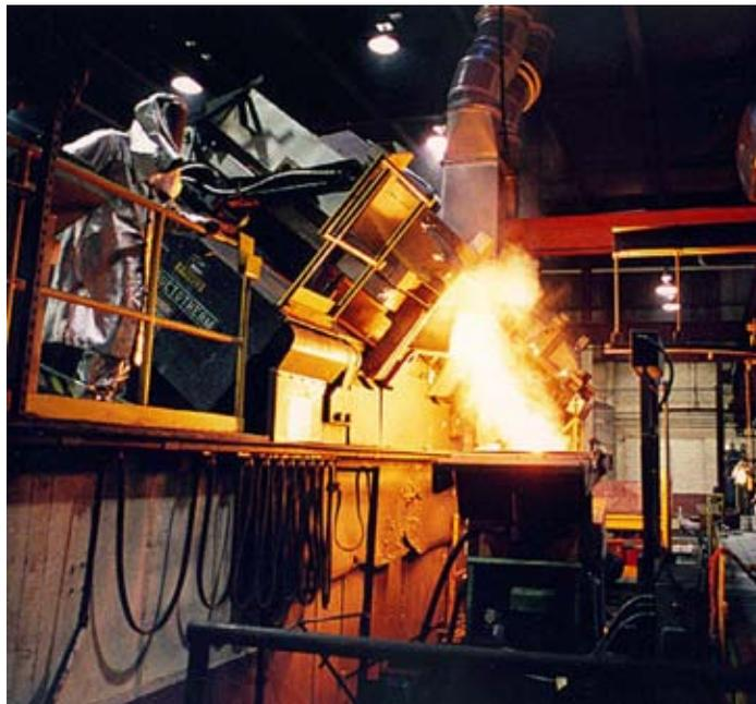
Алитированная куртка, перчатки и съемные нижние части брюк защищают работников плавильного цеха, как от брызг металла, так и от излучаемого тепла. Они также должны носить защиту лица и головы, а также ботинки литейщика без шнурков.
