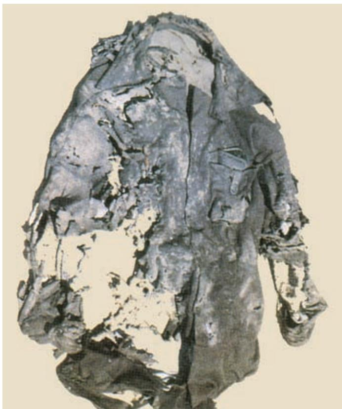
*Когда обычная одежда загорелась от расплавленного алюминия, рабочий получил смертельные ожоги. Огнеупорная одежда могла спасти его жизнь.*
