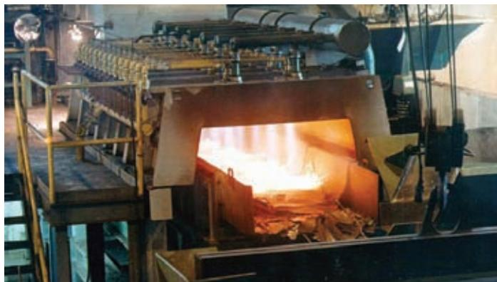
Системы газовой или топливной сушки шихты и подогрева осушают поверхностную влажность на шихте перед завалкой в печь.
