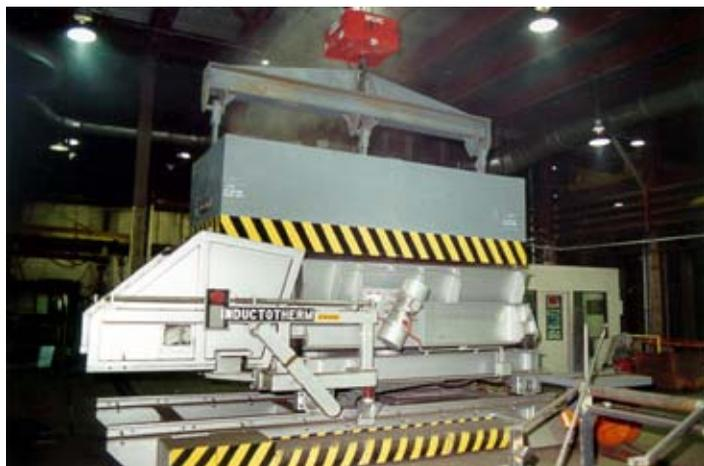
Загрузочная корзина, перевозимая мостовым краном, сбрасывает шихту в завалочную тележку
